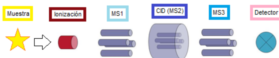
Figura 7. Esquema general de un espectrómetro de masas en tándem espacial. (MS 1 primer cuadrupolo separador de masas, CID, MS 3 segundo cuadrupolo separador de masas) [60] .
