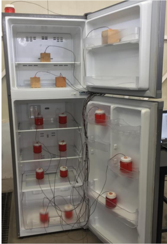
IMAGEN 3. Refrigerador con termopares dispuestos para la prueba de referencia. Fuente: Autores
