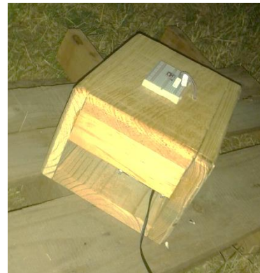
Figura 4: Medidor de radiación UV en su estuche de madera.
