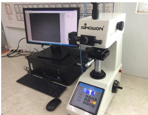
IMAGEN 3: Durómetro para medir la dureza vickers.
