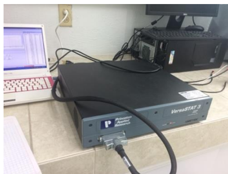
IMAGEN 2: Potencióstato utilizado para medir Tafel.
