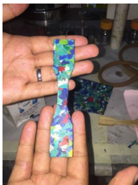
IMAGEN 4: Probeta de tipo 4 elaborada con PEAD sin tratamiento
