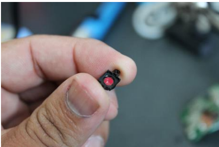
IMAGEN 2: Filtro IR de la Cámara Web.
