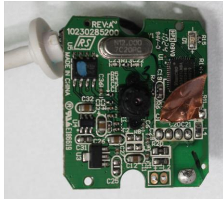
IMAGEN 4: Cámara web armada nuevamente sin el filtro IR.
