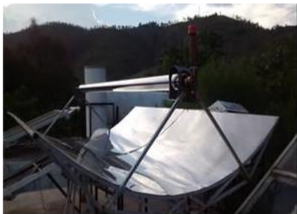
Figura 1: Montaje experimental de la destilación solar
