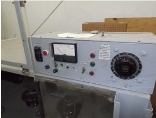
IMAGEN 5: Cámara de niebla empleada en el proyecto
