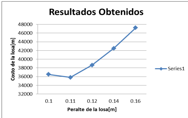
IMAGEN 3: Gráfica que contiene los resultados obtenidos del diseño de la losa maciza de concreto reforzado utilizando las NTC-DF-2004.
