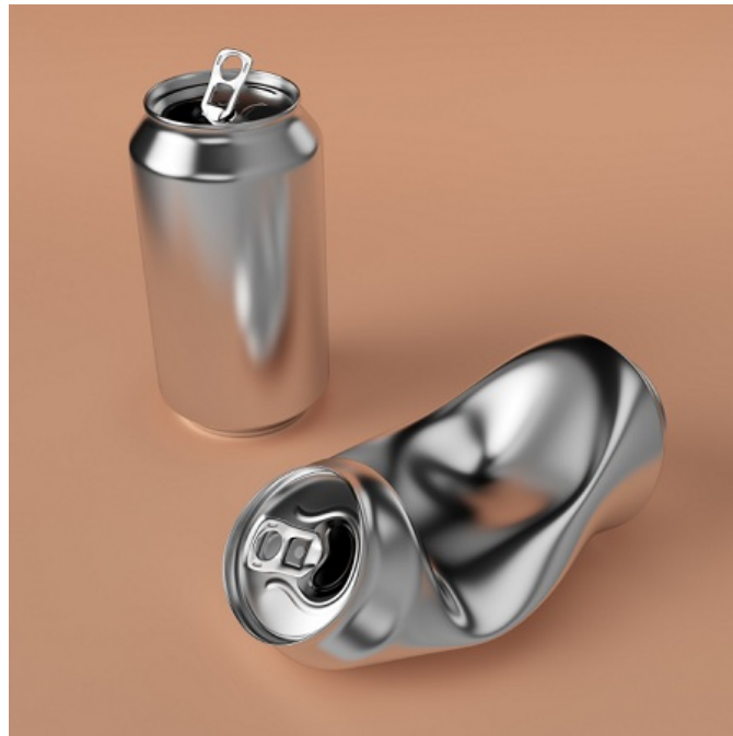
Figura 2.1. Lata de aluminio con y sin pandeo [37].
