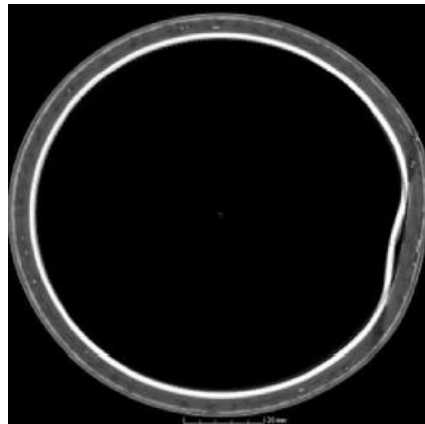
Figura 1.7. Deformación de un revestimiento metálico interno después de ser sometido a un impacto mecánico sobre la superficie externa del tanque [13].
