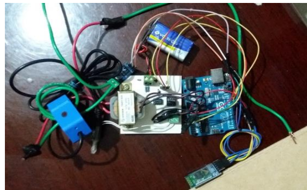
Figura 5: circuito de medición, procesado y envío de datos
