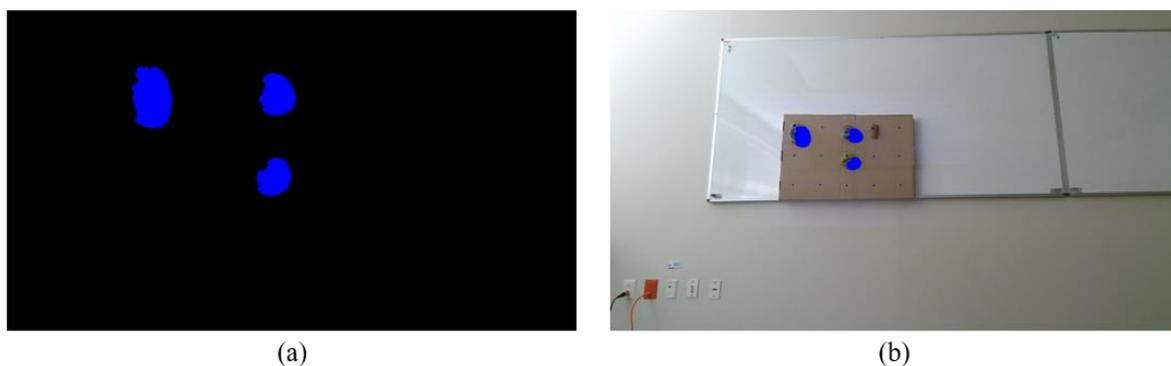
Figura 3.12. Calibración de imágenes en el segundo entorno experimental, (a) Imagen mostrada con el proyector de imágenes, (b) Imagen calibrada al campo de visión de la cámara RGB de Kinect.
