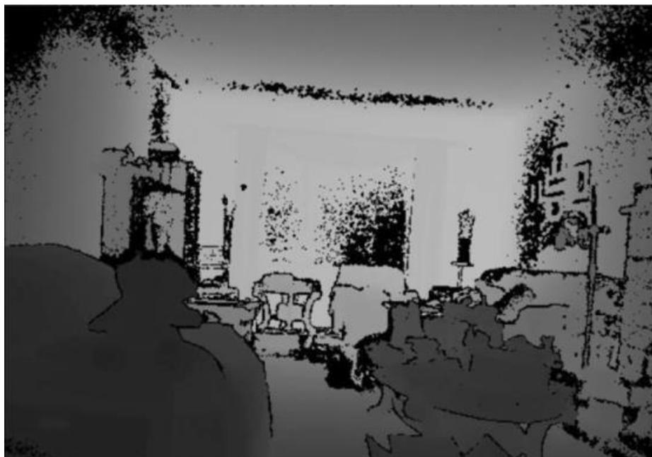
Figura 2.9. Imagen de profundidad creada con Kinect.
