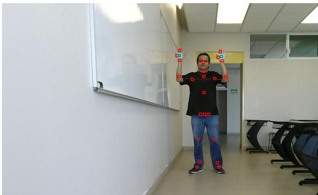
Figura 2.11. Obtención de las coordenadas de las articulaciones de las manos con Kinect v2.0.
