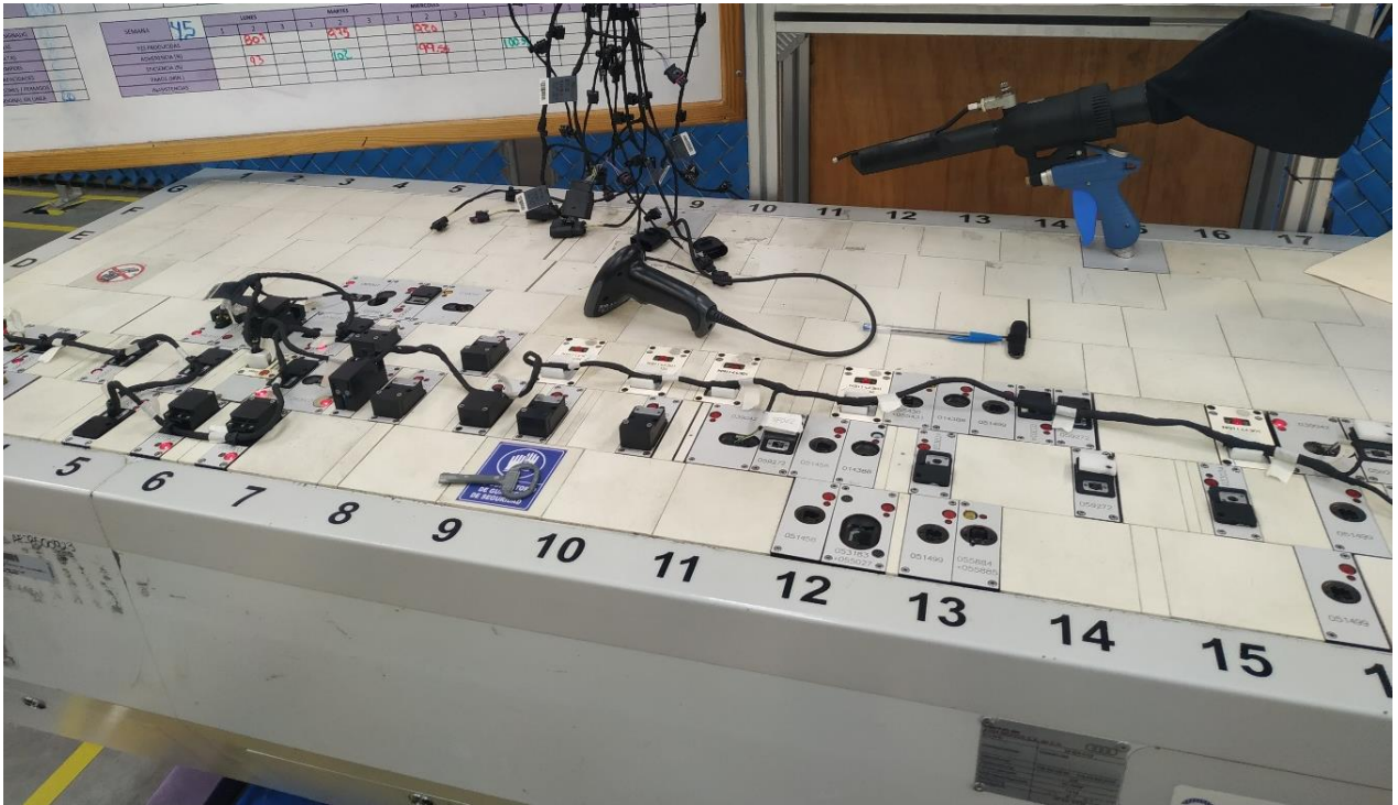
Figura 52. ETB armado y listo para la programación de sus números de parte.
