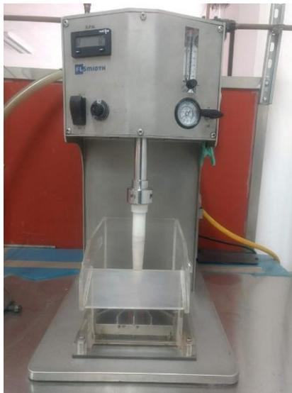
**Figura 12.** Celda de flotación convencional marca FLSmidth Ltda, modelo FTM100.
