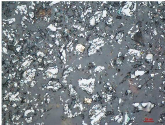
**Figura A2-5.** Fotomicrografía de partícula de magnetita y pirita en la fracción **-635#** en microscopio de luz polarizada, 1,000x. Partículas de magnetita (fase gris brillante), partículas de pirita (fase blanca brillante) y partículas de silicatos (fase gris oscura).
