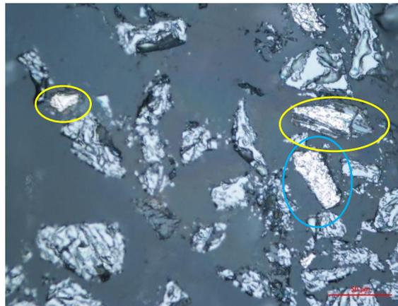
**Figura 16.** Fotomicrografía de la fracción +325# de concentrado de cabeza, microscopio luz polarizada, 500x. Círculos azules señalan partículas de pirita libre, así mismo el círculo amarillo representa una asociación entre magnetita y pirita.
