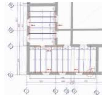
Planta y detalles en planta del refuerzo estructural de vigas de acero desarrollada por Zermeño Méndez, Salvador, en ella se observa la ubicación de los IPR's de refuerzo, 2016-09-20
