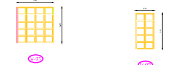
V1.01 VENTANA DE 2.00 X 2.00 DE MADERA BANACK ABATIBLE CON MARCO DE MADERA Y CRISTAL TRANSPARENTE. FRISADA EN AMBOS LADOS CON MARCOS Y CONTRAMARCOS, CHAMBRANAS DE 10 CM DE MADERA BANACK SOBRE EL MURO. V1.02 VENTANA DE 1.15 X 2.35 CON MARCO DE MADERA Y CRISTAL TRANSPARENTE. FRISADA EN AMBOS LADOS CON MARCOS Y CONTRAMARCOS, CHAMBRANAS DE 10 CM DE MADERA BANACK SOBRE EL MURO.
