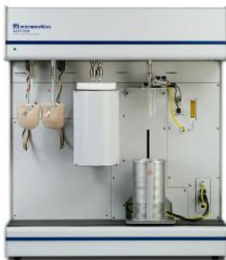
**Fig. 6.1.** Aparato ASAP 2020 (Sistema Acelerado para Áreas y Porosimetría (Micromeritics, 2016).
