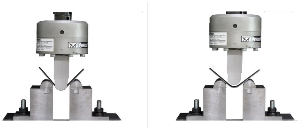
Figura 5.1 Ejemplo de la prueba de flexión antes y después de retirar el punzón al final de la prueba.
