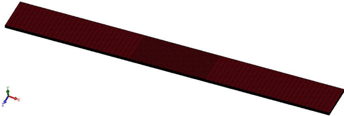
Figura 4.7 Malla de la lámina con elementos sólidos.
