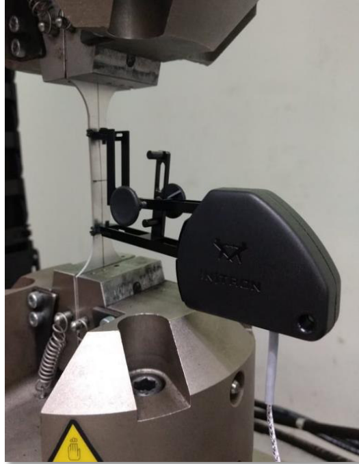
Figura 2.6 Prueba de tensión con extensómetro bajo norma ASTM-E8.
