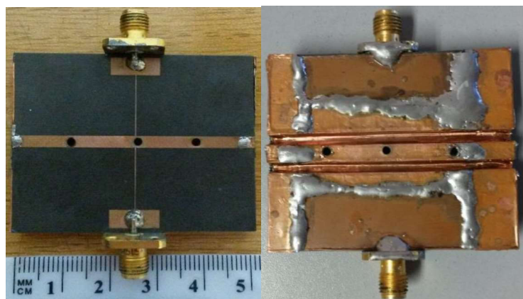
Figura 5.5. Fotografía de cara superior e inferior de la cavidad.
