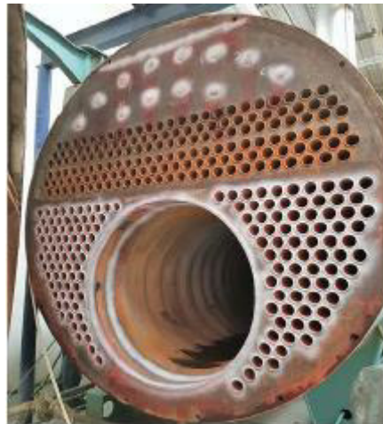
Figura 12. Principio utilizado en la prueba de líquidos penetrantes (Fuente: reporte original de una caldera emitido por una unidad verificadora).
