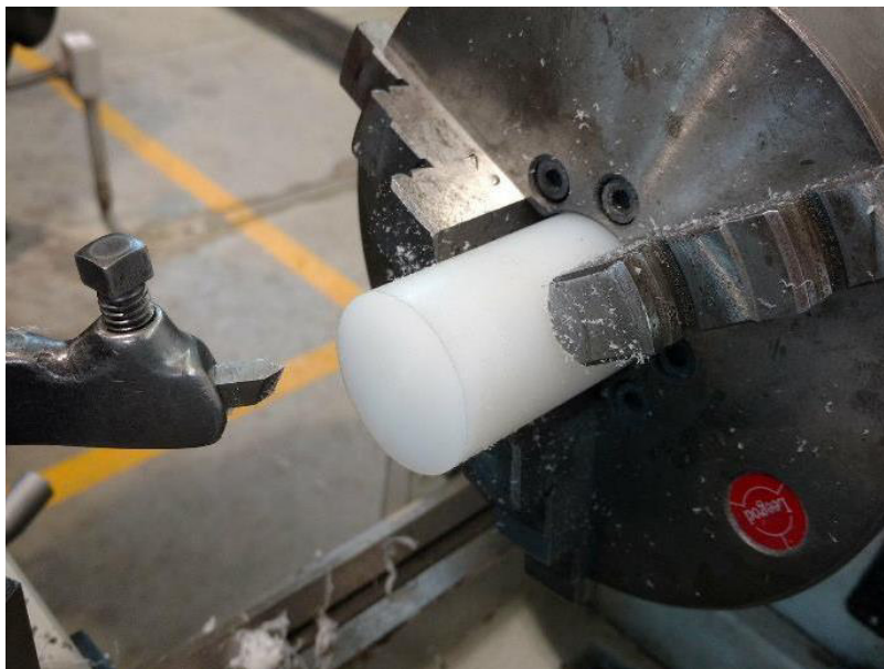
Figura 3.16 Montaje de material - Torno Convencional.
