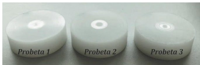
Figura 3.35 Probetas de UHMWPE con desgaste artificial - Pin on Disk (espesor nominal de 12 mm).
