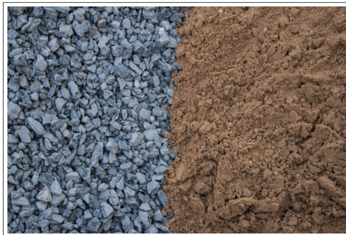
Figura 2.3: La grava y la arena son los agregados más comunes del concreto (Mido-bun, 2018).
