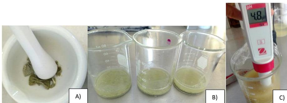
Figura 31. Determinación de pH. A) Triturado de pasta en mortero. B) Pasta troceada con agua desionizada. C) Potenciómetro mostrando la lectura obtenida.
