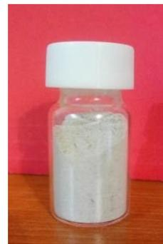
Figura 14. Cenizas de nopal en horno (mufla) a 600 °C
