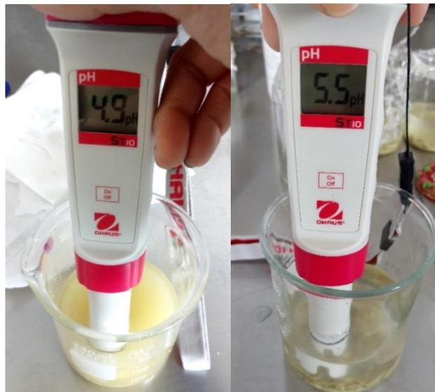
Figura 41. Medición de pH con potenciómetro. A) Pasta seca. B) Pasta cocida.
