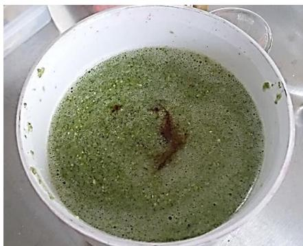
Figura 21. Pasta de harina de nopal lavada con agua desionizada y con gotas de solución de yodo.
