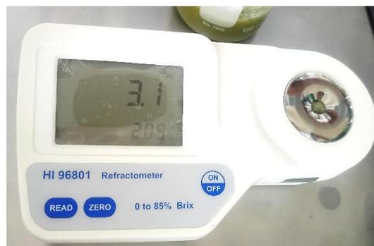
Figura 28. Determinación de °Brix con uso de refractómetro.
