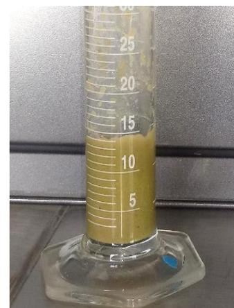
Figura 24. Probeta con muestra de harina de nopal en prueba de CH.
