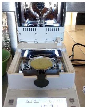
Figura 30. Balanza de humedad con muestra de harina de nopal.
