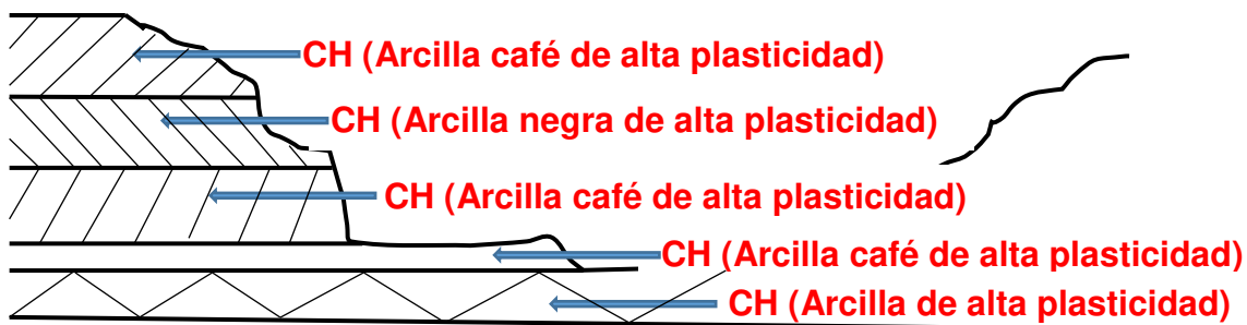
Fig. 3.19 Perfil estratigráfico del lugar de estudio en base al sondeo 1.
