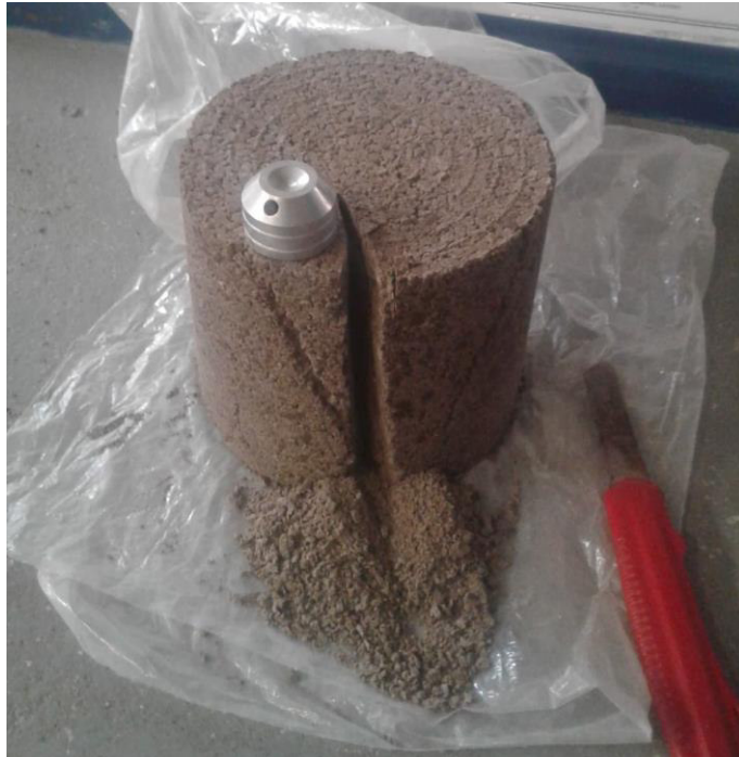
Fig. 3.23 Material trabajado para extracción de especímenes de prueba triaxial.
