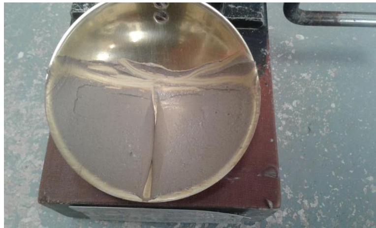
Fig. 3.14 Unión de bordes en prueba de copa de Casagrande.
