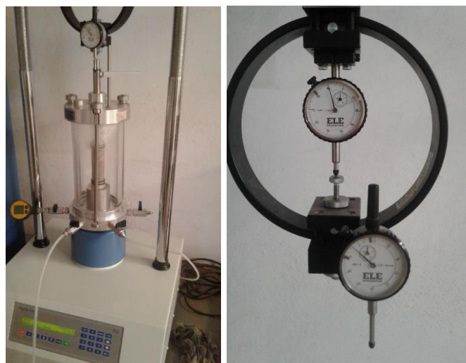
Foto. 3.28 Prueba de Compresión Triaxial Rápida.
