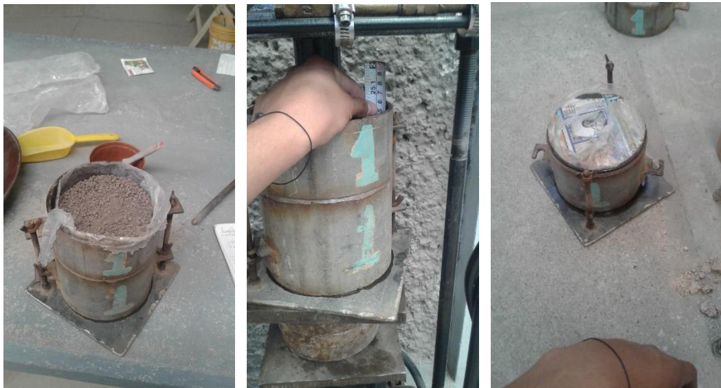
Fig. 3.22 Prueba de compactación de material para remoldeo.
