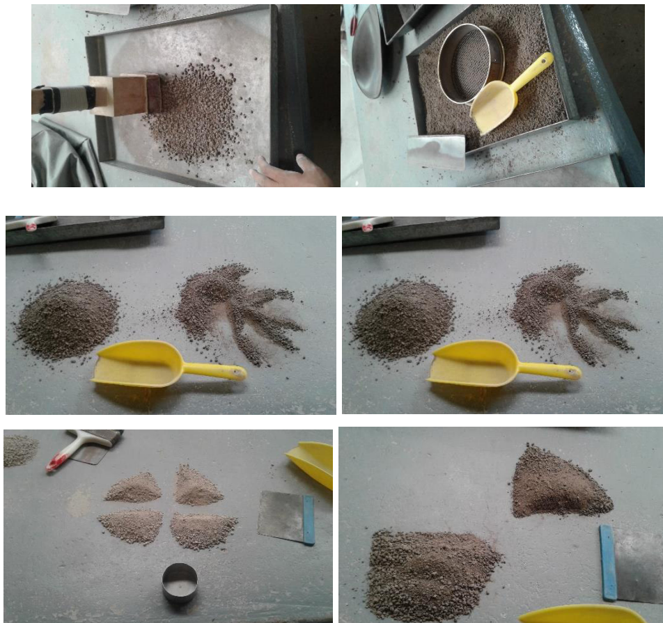
Foto 3.6. Prueba de Secado, Disgregado y Cuarteado
