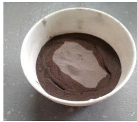
Fig. 3.12 Material utilizado para determinar el límite líquido del suelo
