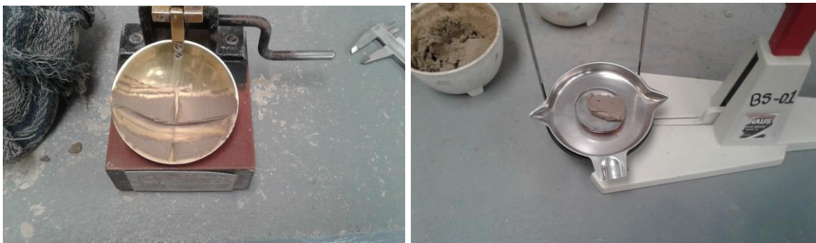
Fig. 3.15 Extracción de material de la copa de Casagrande y pesado.
