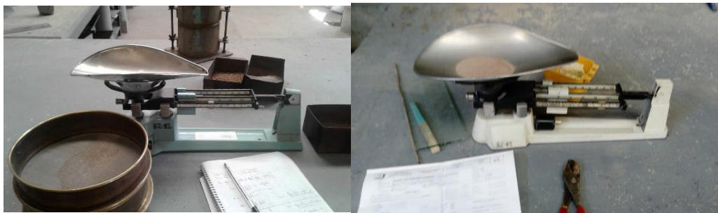
Fig. 3.11 Prueba de Granulometría.
