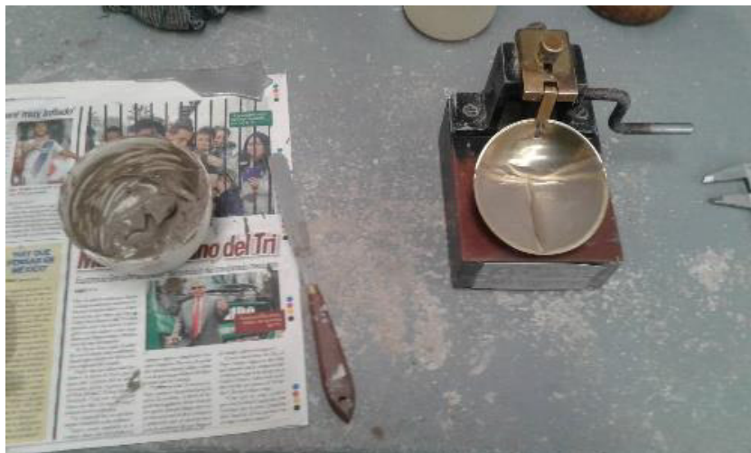
Fig. 3.13 Prueba ASTM D4318.17e1 (Prueba de Límite líquido).
