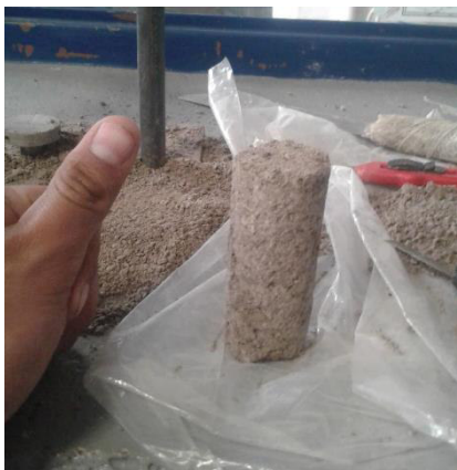
Fig. 3.24 Espécimen para prueba triaxial
