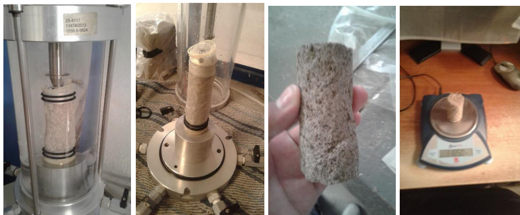
Fig. 3.29 Extracción de espécimen de la prueba uno.
