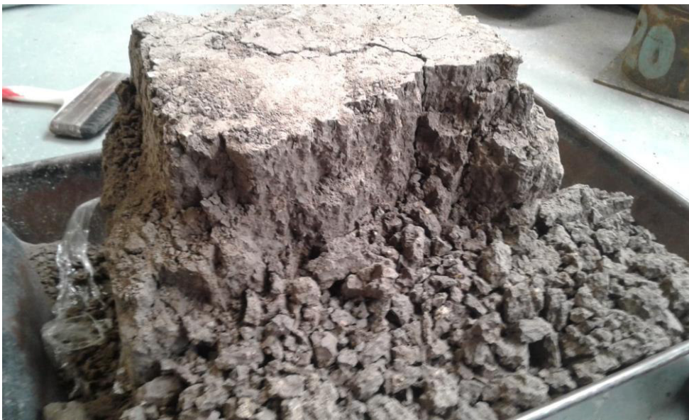
Fig. 3.2 Sondeo 1 agrietado al momento de labrarse.
