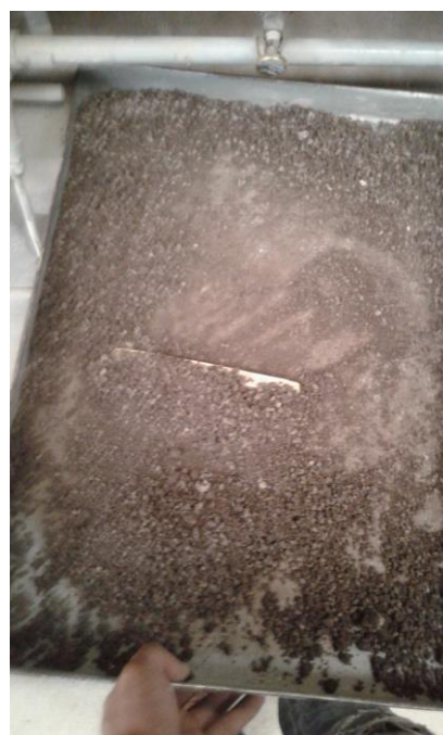
Fig. 3.4 Material expuesto a calor para la pérdida de humedad.
