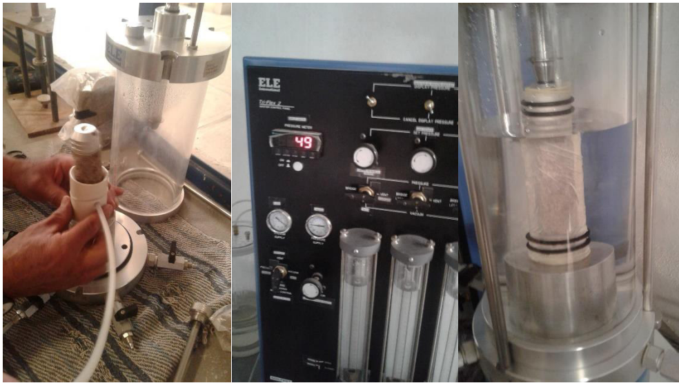
Fig. 3.27 Prueba de Compresión Triaxial Rápida de los Sondeos realizados para prueba 1
