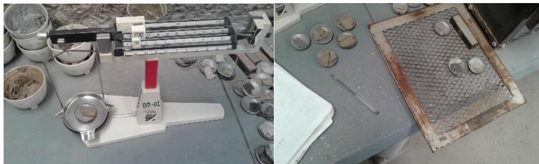
Fig. 3.17 Prueba de Limite Plastico
