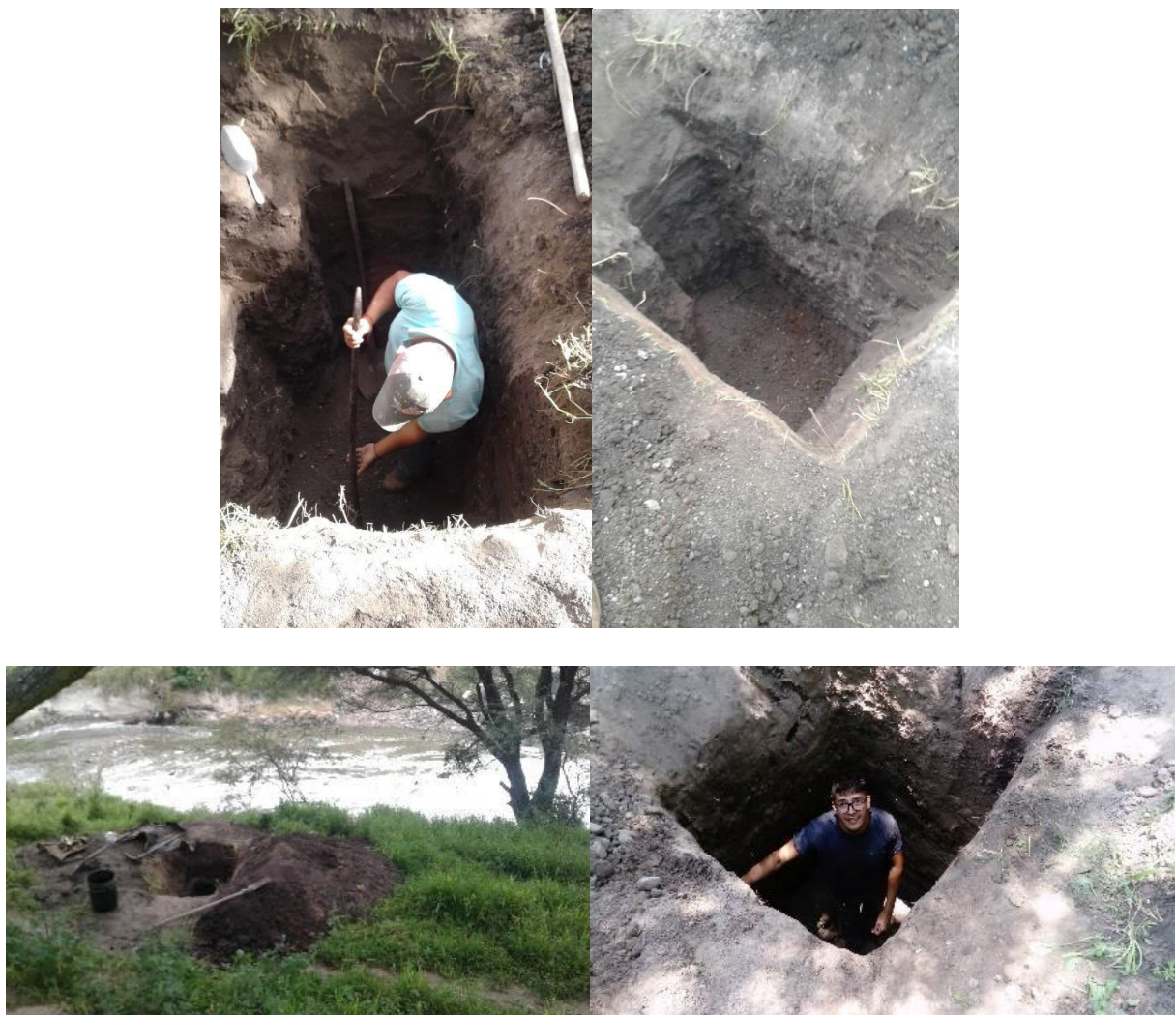
Fig. 3.21 Sondeo 1 y 2 a cielo abierto.
