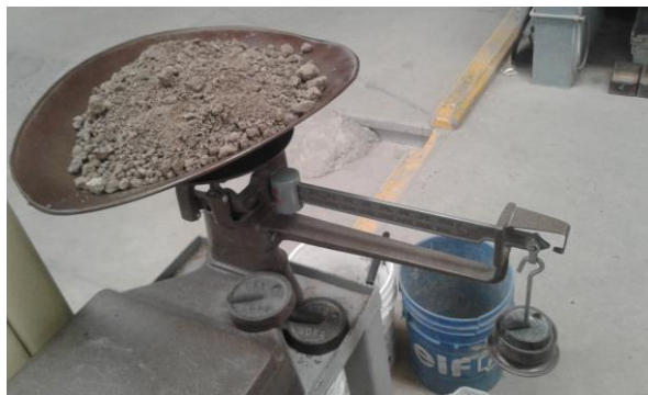
Fig. 3.3 Peso húmedo de material para prueba ASTM.
