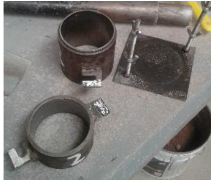
Fig. 3.21 Molde para prueba de compactación.
