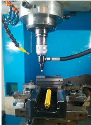
Figura 2.6: Bruñidor de bola hidrostático [49].
