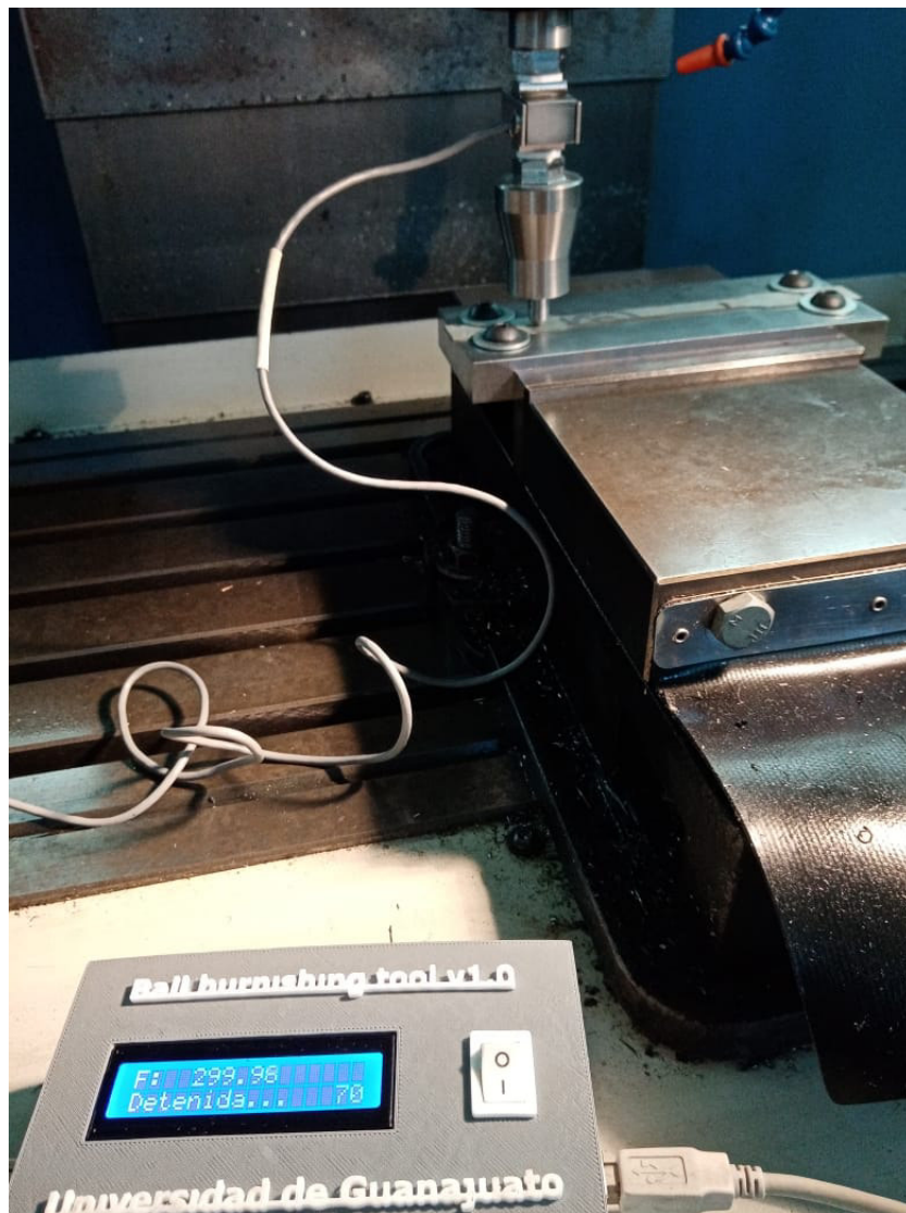
Figura 3.3: Herramienta de bruñido con sistema de adquisición de datos.
