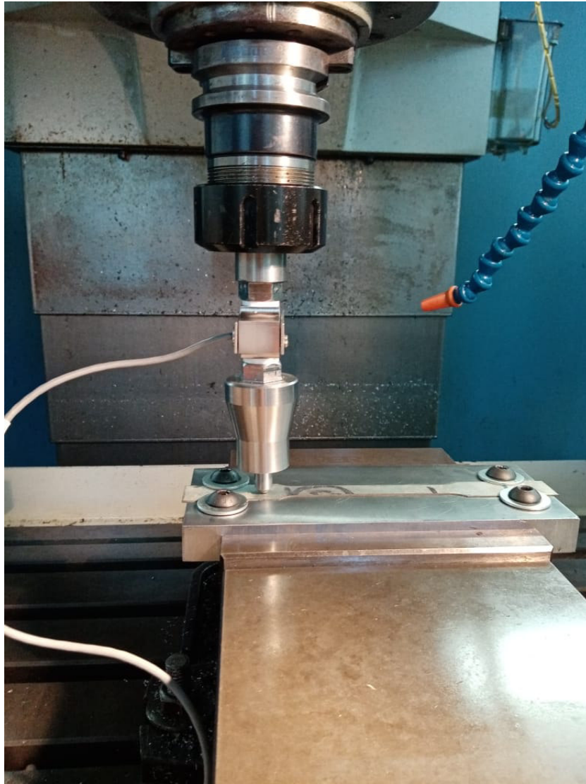
Figura 3.4: Probeta sujeta en el molde durante el proceso de bruñido.
