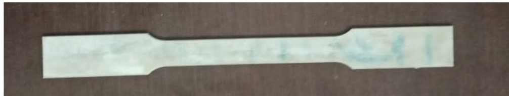
Figura 3.1: a) Geometría con base en la norma ASTM E-8 y b) Espécimen cortado por láser.
