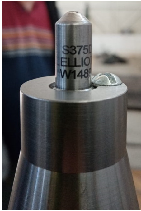
Figura 2.8: Punta de bruñidor con fragmento de diamante utilizada para este proyecto.
