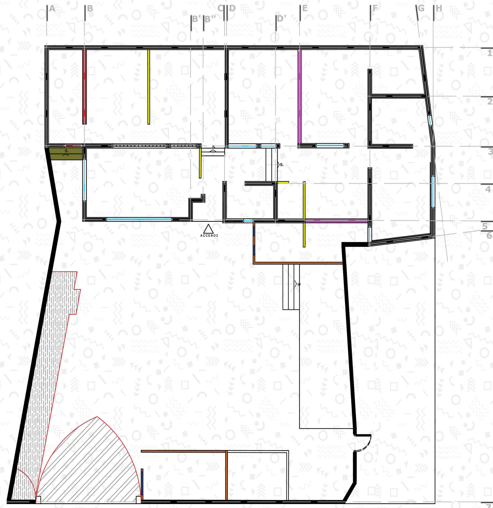
PLANTA ARQUITECTÓNICA (Demoliciones y agregados)
