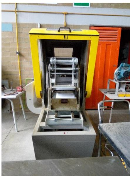
*Figura 2.6 – Compactador de placa empleado*
