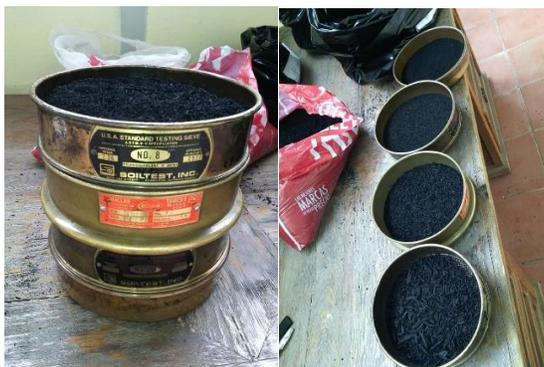
Figura 2.2 – Clasificación por tamaño de viruta de llanta
