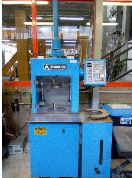
*Figura 2.5 – Compactador giratorio para elaboración de probetas*
