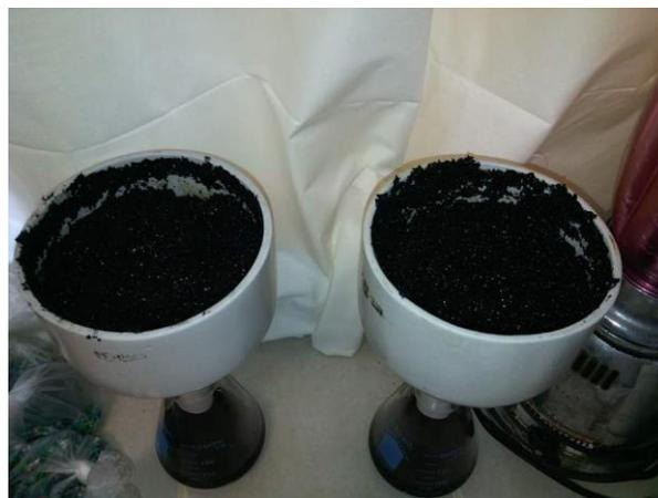
*Figura 2.4 – Separación por filtración de productos de reacción*
