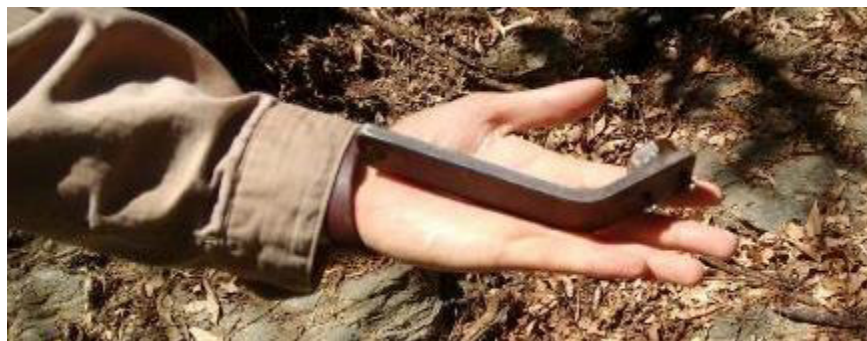
Figura 13. Llave para quitar la tapa de la camisa de cobre.
