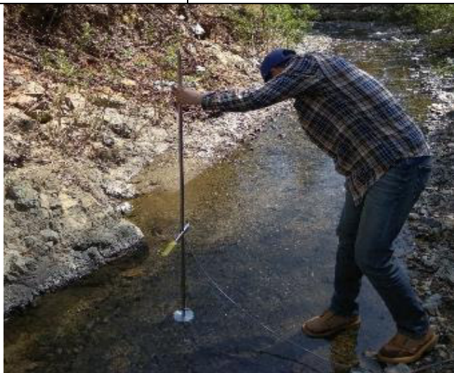
Figura 24. Medición de velocidad en Velocímetro electromagnético
