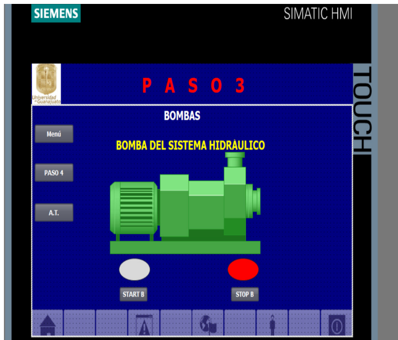
(a) Estado inicial de la bomba, en estado de paro.
