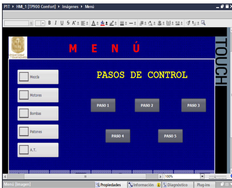
Figura 4.4: Menú o pantalla principal del HMI.
