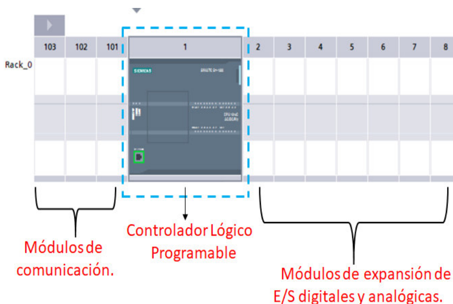
Figura 4.1: PLC con montaje tipo rack y módulos de expansión y comunicación.
