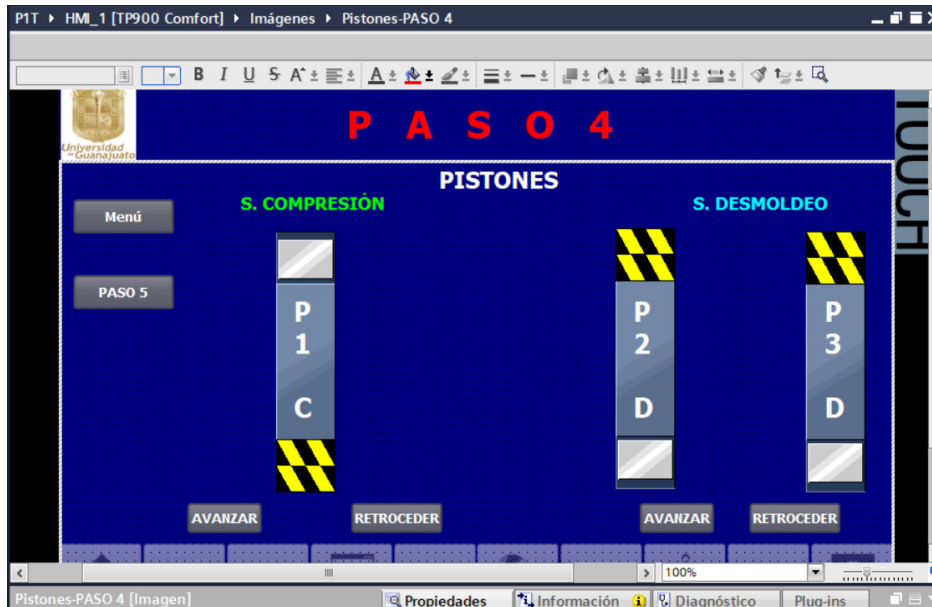
(a) Estado inicial los actuadores hidráulicos.
