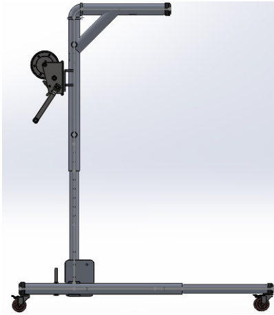
Imagen 74. Grúa con las tres primeras mejoras, vista lateral estando erguida en la posición máxima
