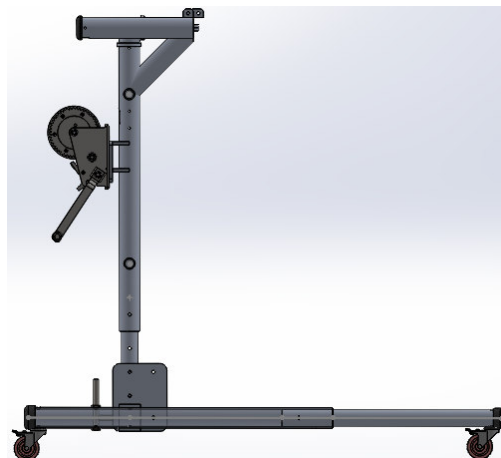
Imagen 78. Grúa con la cuarta mejora, vista lateral estando erguida en la posición mínima con el soporte superior plegado
