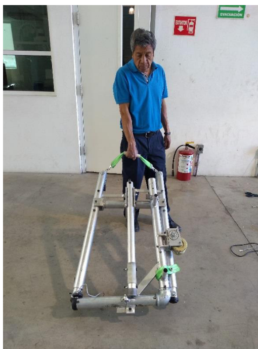
Imagen 120. Grúa estando plegada
