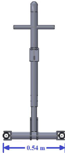
Imagen 70. Grúa con junta recortada, vista posterior
