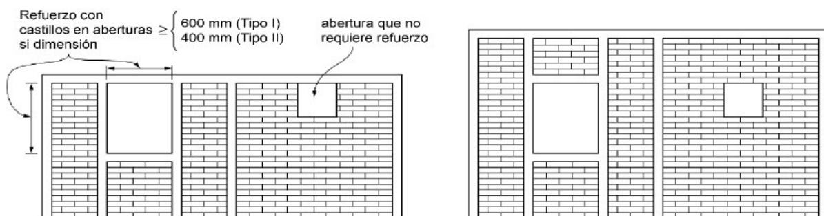
Figura 5.33 Aberturas en muros de mampostería.
