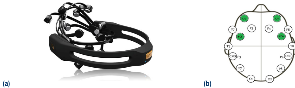
IMAGEN 1: Emotiv-Epoc (a) Auriculares; (b) disposición de electrodos del auricular
