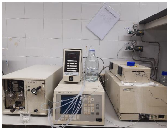
Figura 3.3. Cromatógrafo Waters 600 empleado para el análisis de la concentración de los contaminantes.
