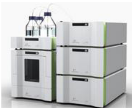
Figura 3.5. Cromatógrafo iónico empleado en el análisis de iones.
