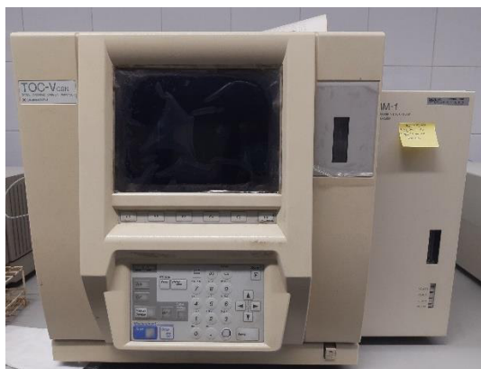
Figura 3.4. Equipo Shimadzu VCSN empleado para el análisis del carbono orgánico total.
