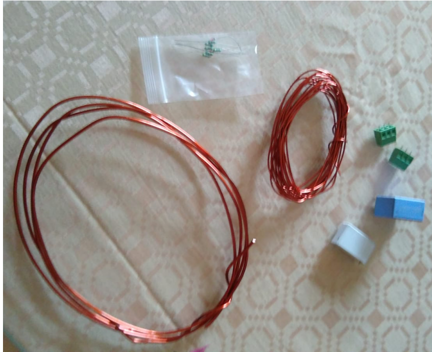
Figura 4 Resistores y diodos con alambre AWG calibre 11 y 16, capacitores de película 0.47uf 400V y borneras
