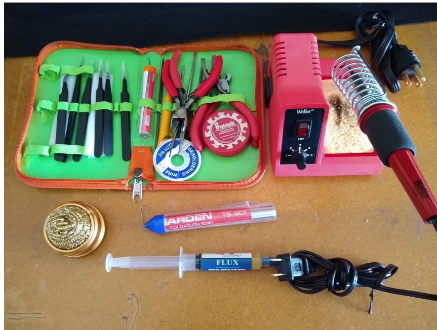
Figura 6 Herramientas para soldadura del circuito, pinzas antiestáticas, alicates, cautín Waller 40W, pasta Flux y estaño
