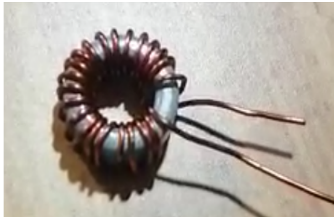
Figura 11 Inductor toroidal fabricado a mano.
