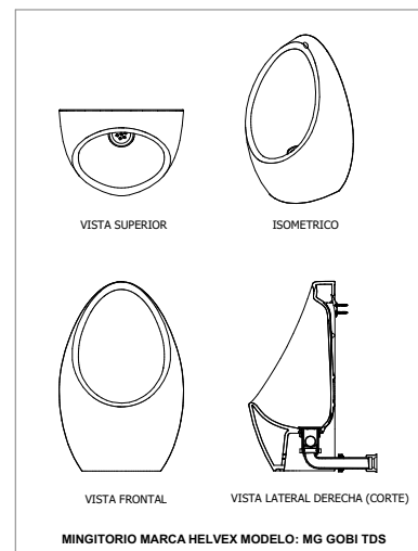
DET-04. DETALLE MINGITORIO S/ESC
