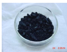
Fig. 2 Pasta \text{NH}_4\text{Cl} , \text{ZnCl}_2 , \text{MnO}_2 y grafito de la pila ácida de desecho tipo AA.
