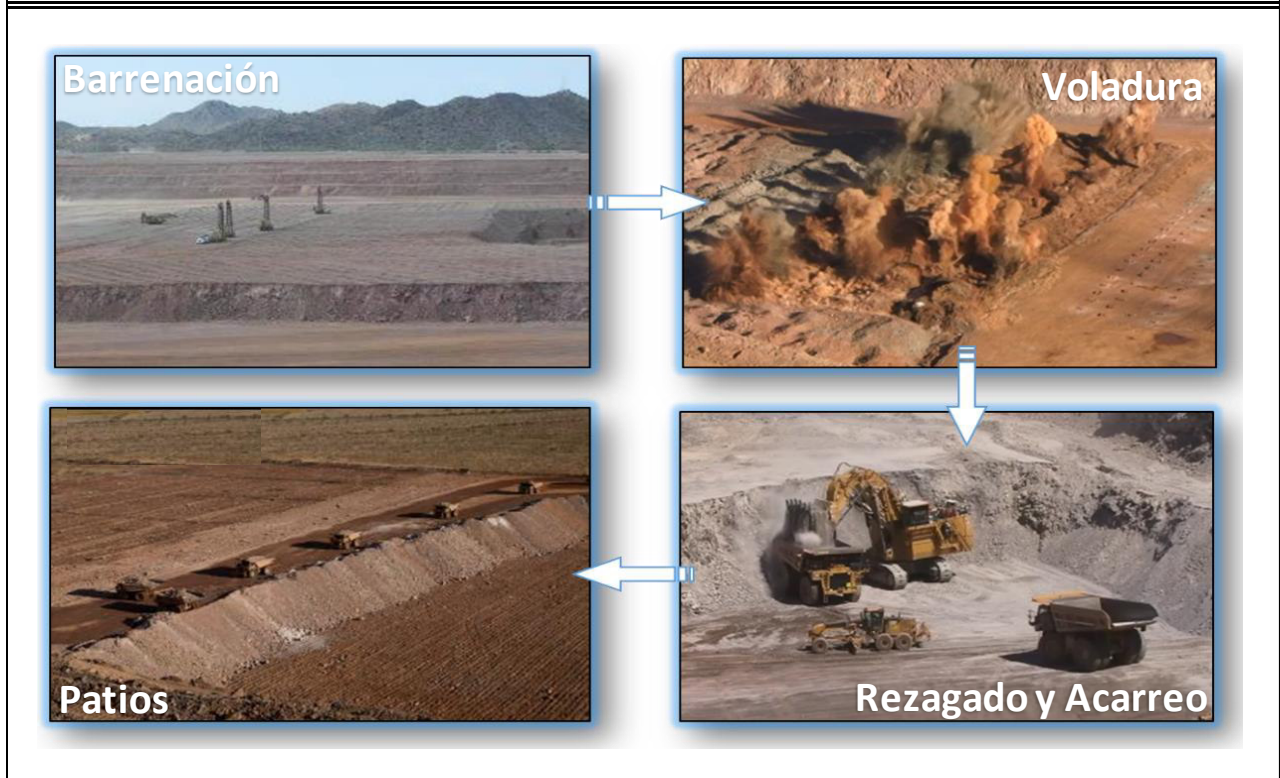
Figura 14 Representación Simplificada del Sistema de Minado en el Tajo Santa Ana.
