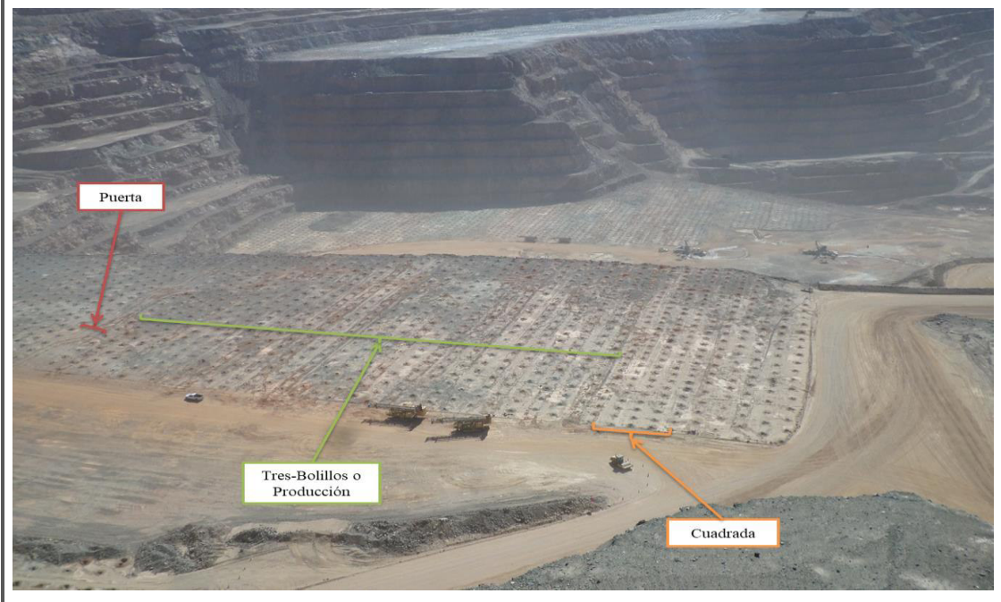
Figura 2 Plantilla de Barrenación . En la imagen se muestra una plantilla de barrenación del área de producción del Tajo Santa Ana de Mina La Encantada, proporcionada por el Departamento de Topografía.
