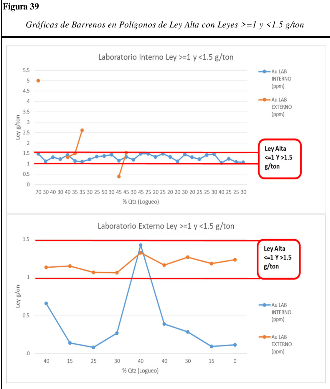
Figura 39 Gráficas de Barrenos en Polígonos del Ley Alta con Leyes \geq 1 y < 1.5 g/ton. Graficas Comparativas en donde se analizan las Leyes de Au \geq 1 y < 1.5 g/ton (correspondientes para polígonos de ley alta) de 29 barrenos según Laboratorio Interno (azul) y de 9 barrenos según Laboratorio Externo (Naranja) Tajo: Santa Ana Mina: La Encantada (Revisar Tabla en Anexos )
