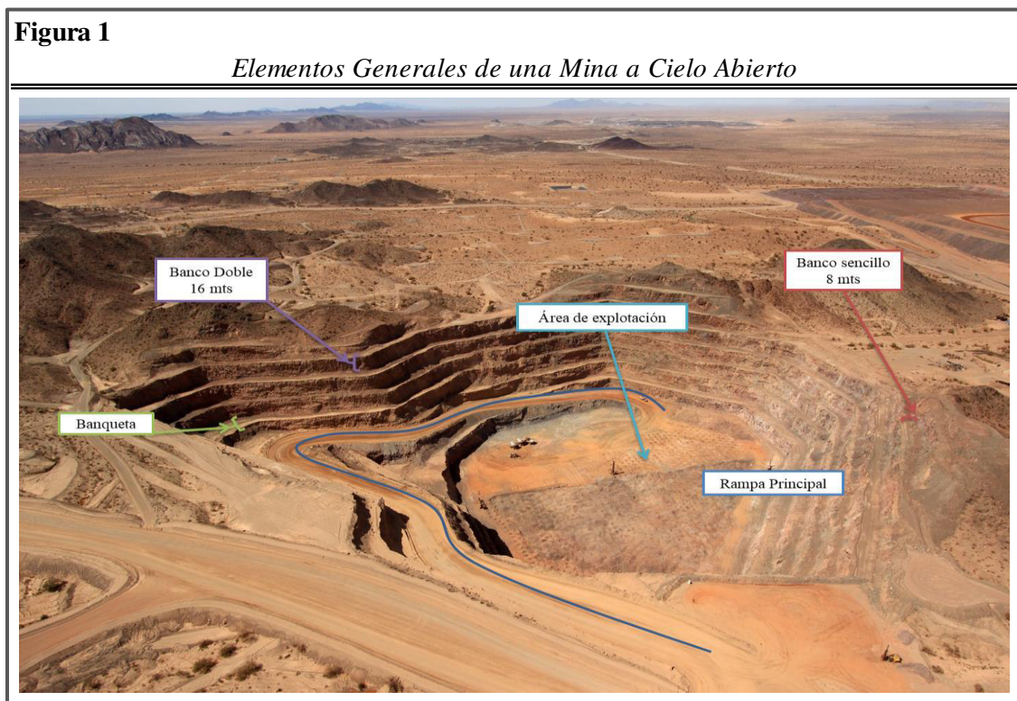
Figura 1 Elementos Generales de una Mina a Cielo Abierto. En la imagen se muestran los términos de los principales elementos que podemos identificar en una mina a cielo abierto.
