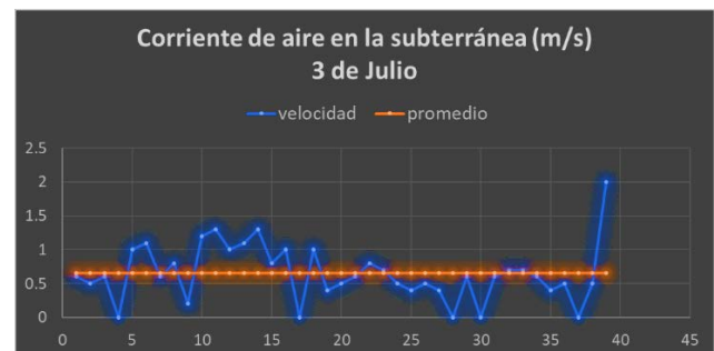
Figura 3. Gráfica 1: Monitoreo de la velocidad del aire en la subterránea. Elaboración propia verano 2019.
