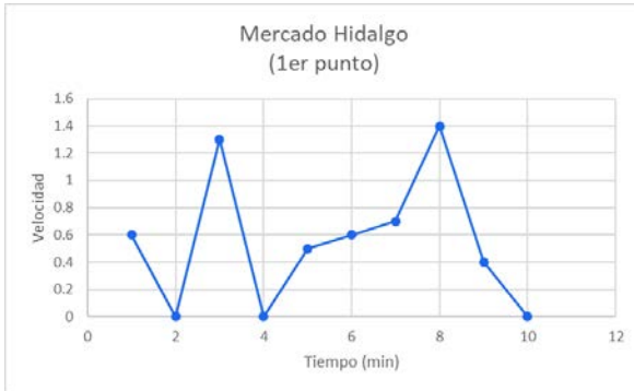
Figura 4. Gráfica 2: Monitoreo de la velocidad del aire en el Mercado Hidalgo. Elaborado por T.V. Salazar Barrientos 2021.
