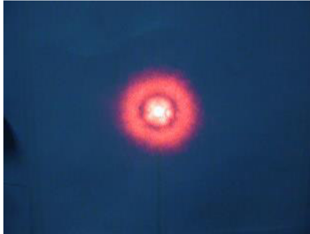
Figura 90.- Patrón de anillos de auto-difracción registrado con el nombre de P1080926-16 mW-s6.
