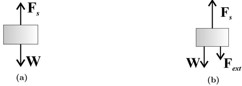
**Figura 2.5.** Diagramas de cuerpo libre para el sistema SDOF masa-resorte. (a) Estático y (b) dinámico.
