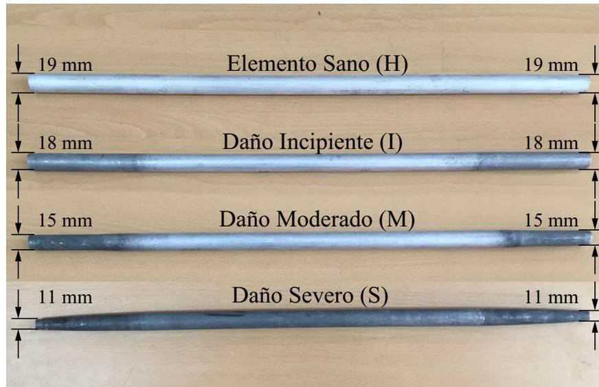
**Figura 4.15.** Elemento de barra en buen estado (19 mm de diámetro en todas las secciones) y elementos de barra con los diferentes niveles de corrosión (1 mm, 4 mm y 8 mm de reducción de diámetro).
