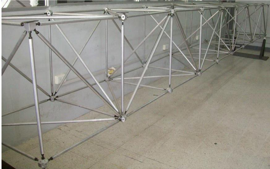
**Figura 3.3.** Estructura puente tipo armadura.
