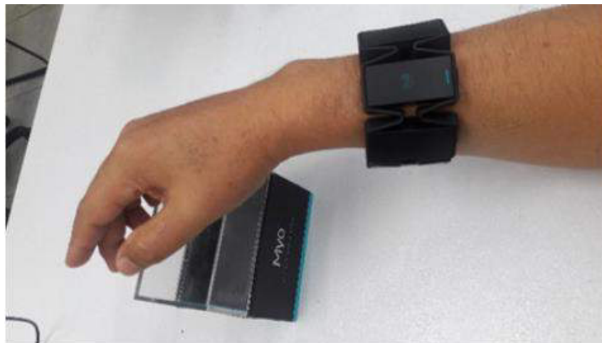
Figura 26. Un sujeto lleva un brazalete Myo en el antebrazo.
