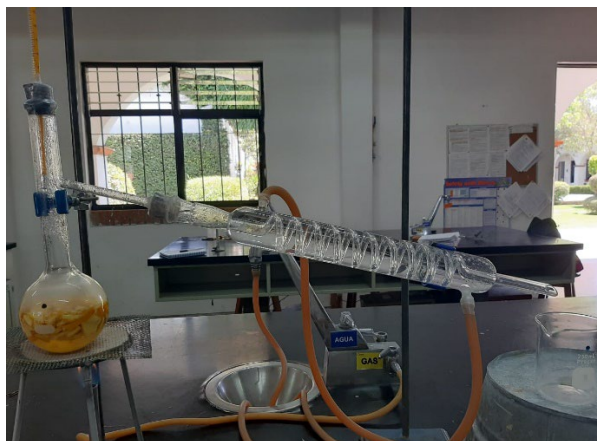
Figura 2. Equipo de destilación por arrastre de vapor. (Rafael, P. 2020).
