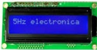
Pantalla LCD 16X2 Fig.8
