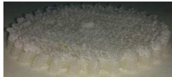
Figura 4: Defecto de impresión por obstrucción de extrusor.
