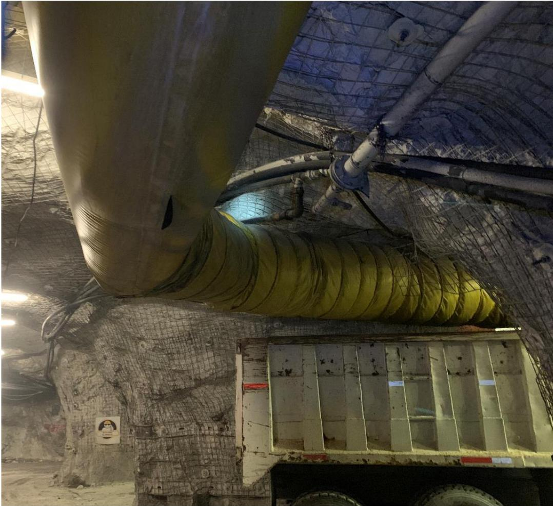
*Ilustración 5 Ventilación Auxiliar o Secundaria del Distrito San Dimas*
