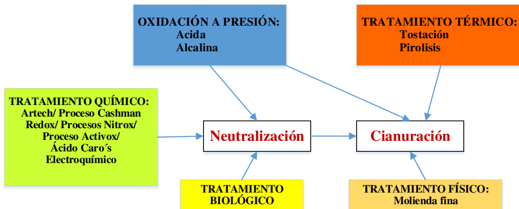
Figura 2.1.- Opciones generales de proceso para pretratamiento en minerales refractarios (La Brooy, Linge et al., 1994).
