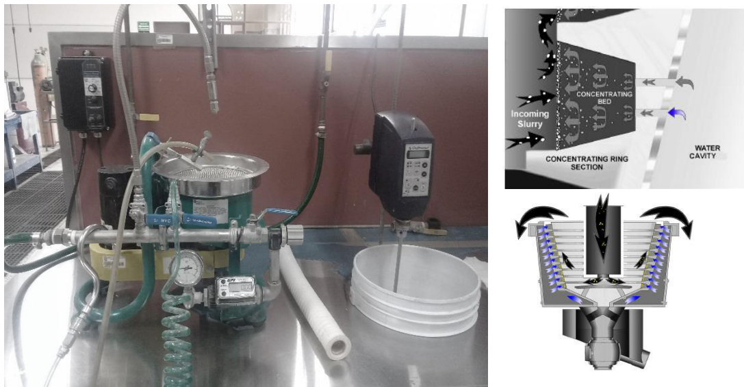
Figura 3.2.- Detalles y esquemas del concentrador gravimétrico K-Nelson, modelo KC-MD3, de laboratorio, capacidad 10 kg.
