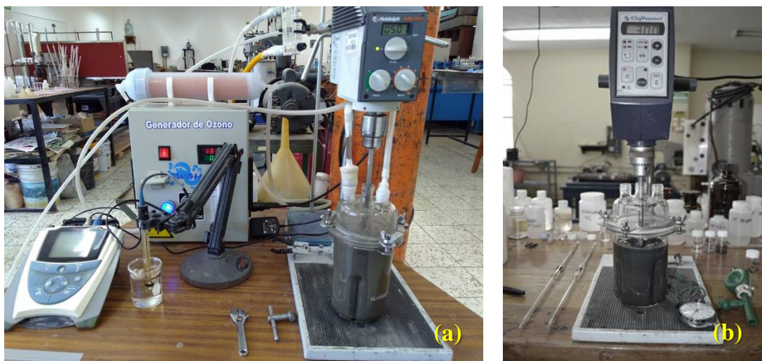
Figura 3.5.- (a) Sistema de ozonización y (b) cianuración de sólidos ozonizados por 24 h.
