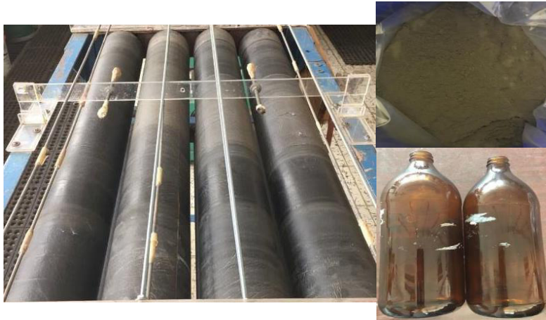
Figura 3.8. Sistema empleado para realizar proceso de cianuración.
