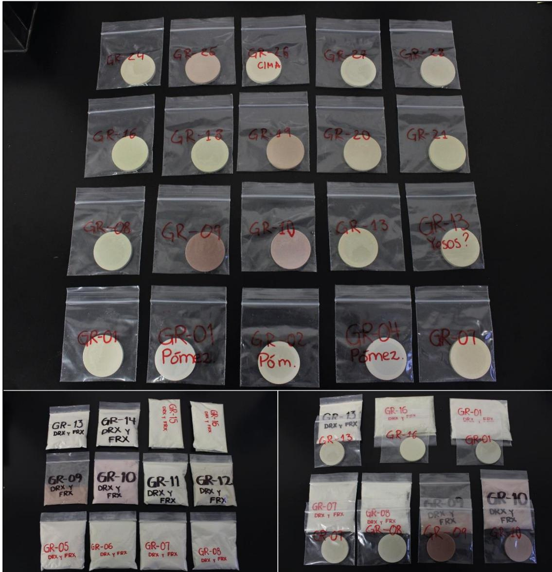
**Figura 48.** Procedimiento para el análisis por FRX. La figura superior muestra el total de pellets realizados para el estudio. Los pellets son pequeñas pastillas circulares de 3 cm de diámetro, que son introducidas al espectrómetro de fluorescencia de rayos X. La figura inferior izquierda contiene los polvos empleados en la preparación de los pellets, mientras la inferior derecha los polvos con su respectivo pellet elaborado.
