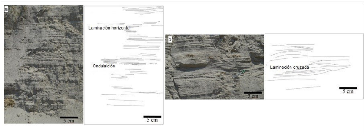
Figura 8. Fotografía de estructuras de sedimentos blandos como resultado de un fenómeno de licuefacción y fluidización en los jales de Noria Alta: a) Laminación horizontal y ondulación; b) Laminación cruzada.
