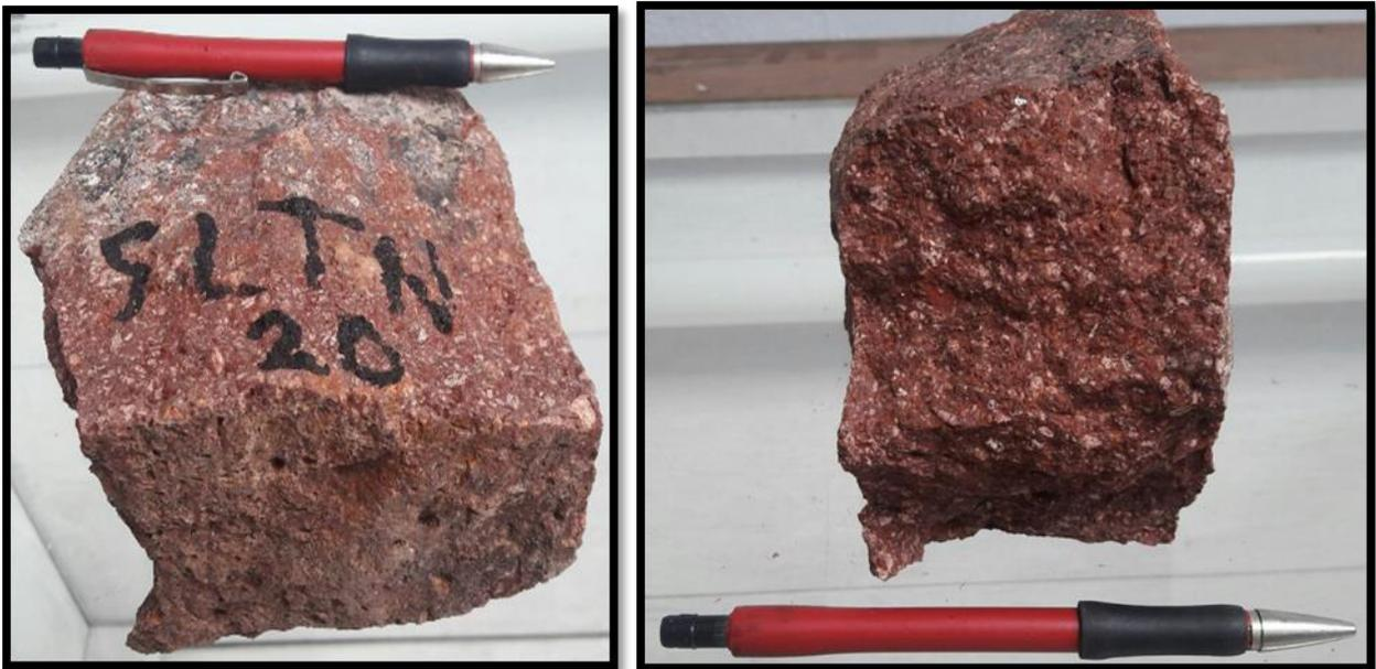
*Figura 20.* En las imágenes se aprecia el alto grado de oxidación que presenta la roca, tanto en la matriz como en los cristales de cuarzo y ortoclasa, a simple vista es posible detectar que presenta un soldamiento débil, generado principalmente por la oxidación que la afecta. Esta roca presenta características físicas y químicas muy distintas a las demás, factor que hace asumir que proviene de un domo traquidacítico con características muy distintas a las demás muestras.
