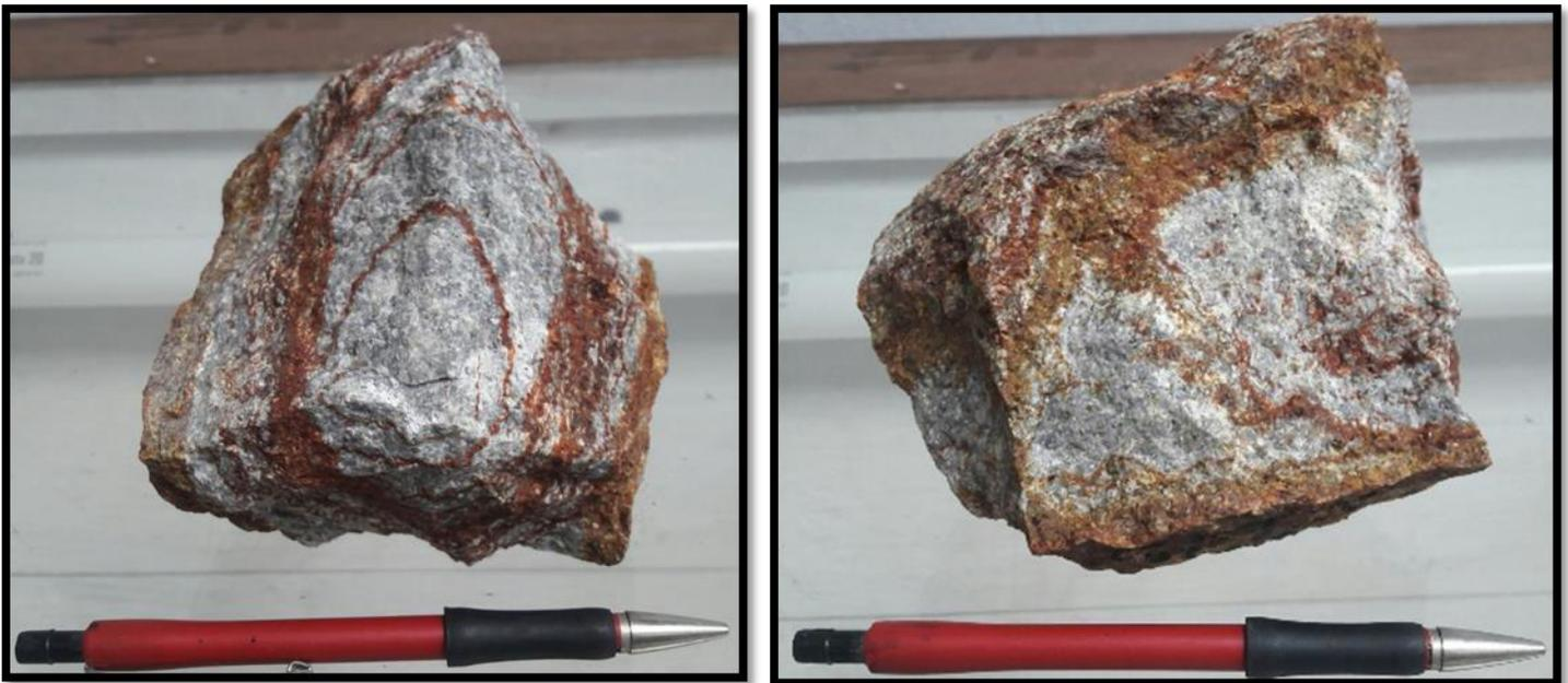
*Figura 18.* En las imágenes se aprecia la textura concéntrica generada por un posible enfriamiento rápido en la matriz derivando en zonas oxidación en forma concéntrica
