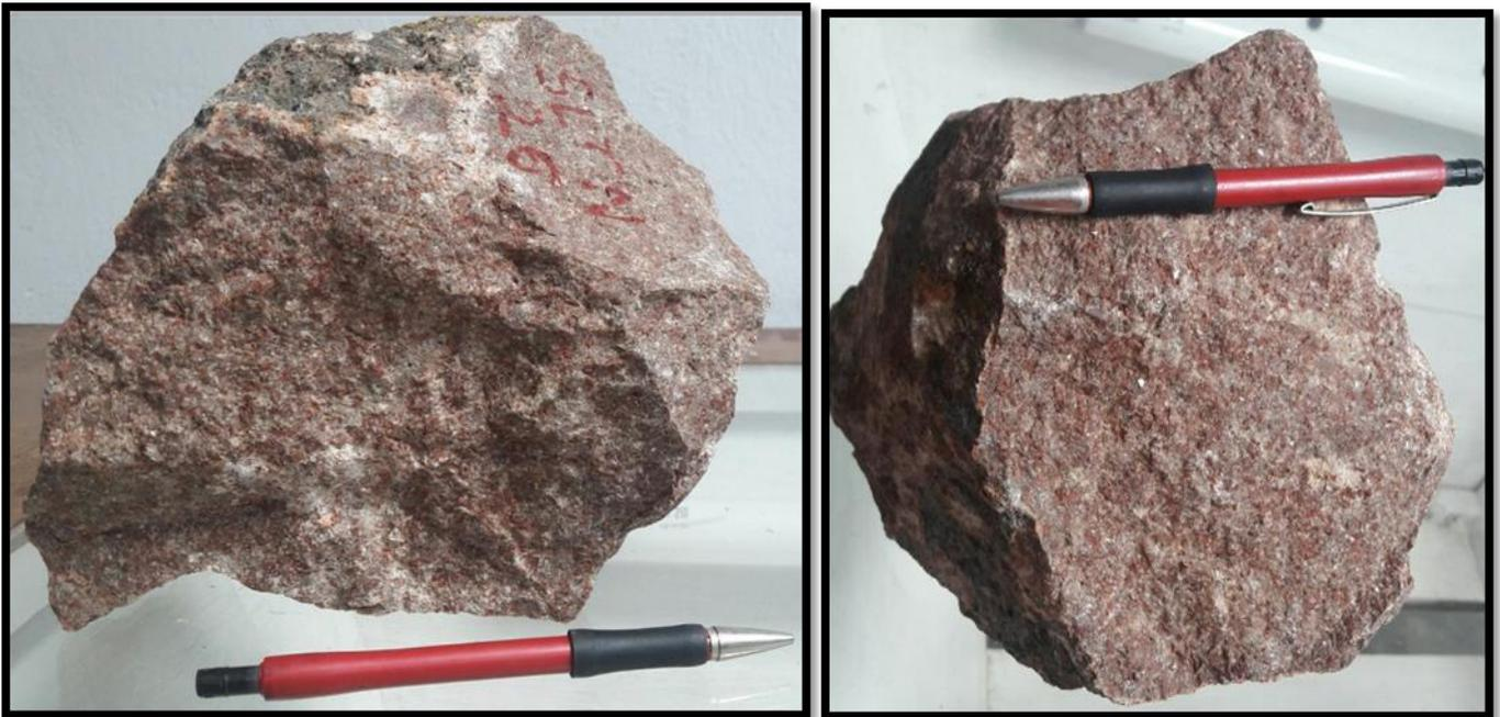
*Figura 21.* En las imágenes es posible detectar la textura fanerítica arenosa, no se aprecia bandeamiento de flujo como en la mayoría de las otras muestras de riolita. Las partes blancas en la roca corresponden a alteración argílica y las coloraciones rojas a cristales de cuarzo y plagioclasas con oxidación moderada.
