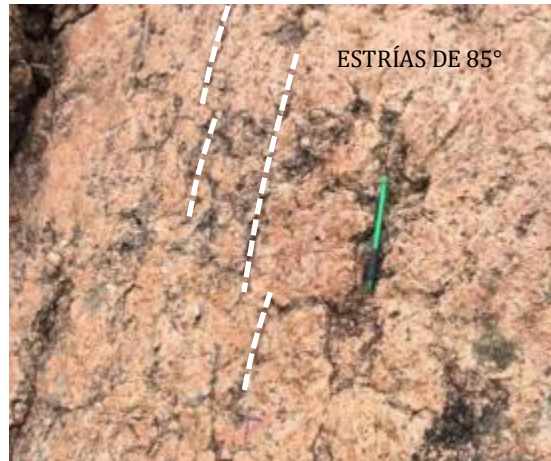
Fig. 80. Plano de falla en ignimbrita mostrando estrías de 85^\circ a 90^\circ .
